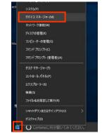
⑨ 「ポート(COMとLPT)」を開き、「SEED-CM4U-A(COM\*)」をダブルクリックします。 通信モジュール(SEED-CM4U-A)に電源が投入されていない場合、デバイスマネージャー には表示されません。電源を投入してください。
